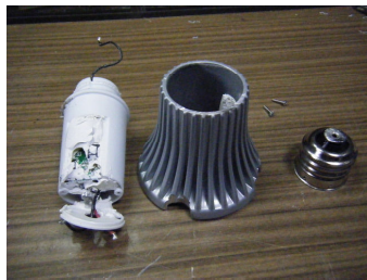
LED基盤を外し、口金・電源部も取除く(写真は60W)
