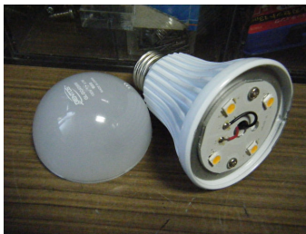
LED電球の半円形カバーを外す(写真は40W)
