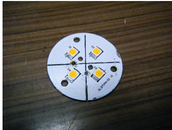
LED基板を金鋸で4分割にカット(写真は40Wタイプ)
