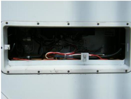
この状態で、オリフィスの掃除をしようとすると、本体を止めているネジ4本外し、ガス配管も外したのち重たい冷蔵庫本体を室内へ引張り出さないとオリフィスの掃除は出来ない。大変な工数が掛かる！
