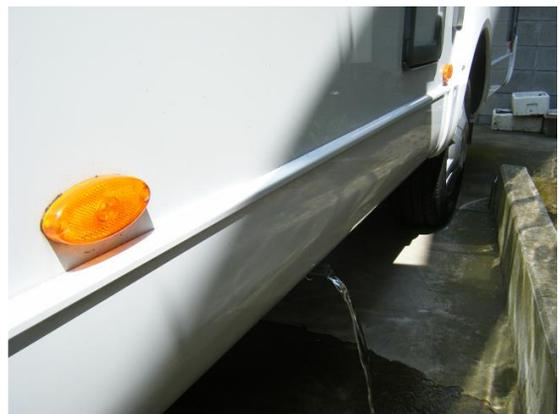
塩ビのパイプとバルブを使用しアルミスカートにステンレスのネジで固定
