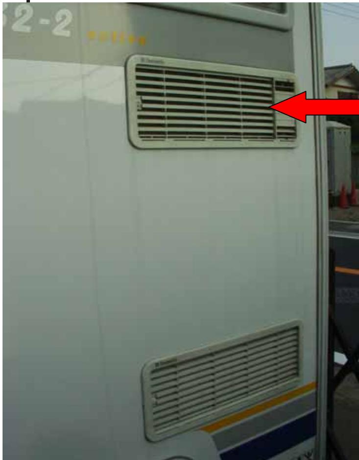
ガスで運転中、排気口に手をかざすがあまりあったかくない。FANが回っているから??でも、ガスはちゃんと燃えている。ひょっとしたら、オリフィスの目詰まり?とオリフィスを外して見ることにする。作業時間は30分位でした。難易度中、ガス管の取り外し接続作業があります、**作業する場合は十分注意をし自己責任でお願いします。**
