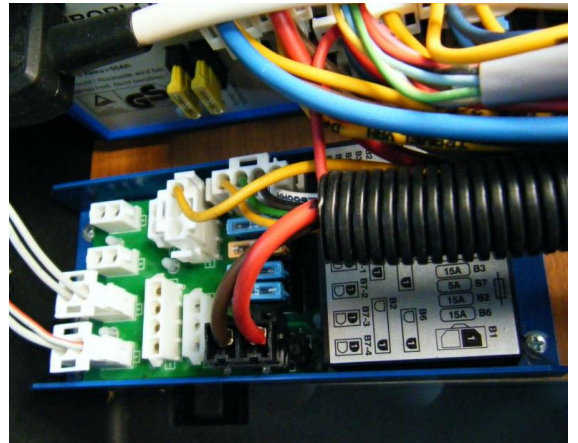
スモール電源はリレーBOX内のサイドマーカーより
