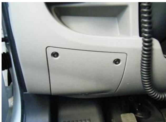
運転席側ウインカー取出しは、ヒューズがあるカ-を外す
