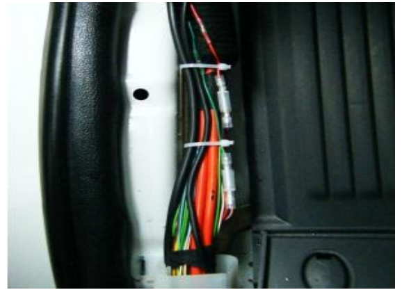
カバーを外すと「ピンク/紫」の線があるので切断しリレーへ
