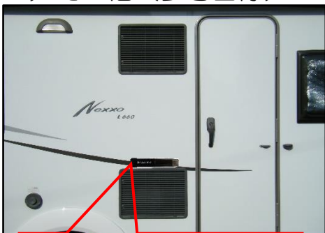
外壁データロガー取付場所
