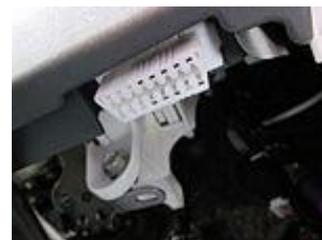
レーダー探知機や外部メーターを専用のケーブルで「OBDIIコネクタ」に接続し、走行中の水温やブースト圧、燃費などを表示する機能が備わった機器も登場
