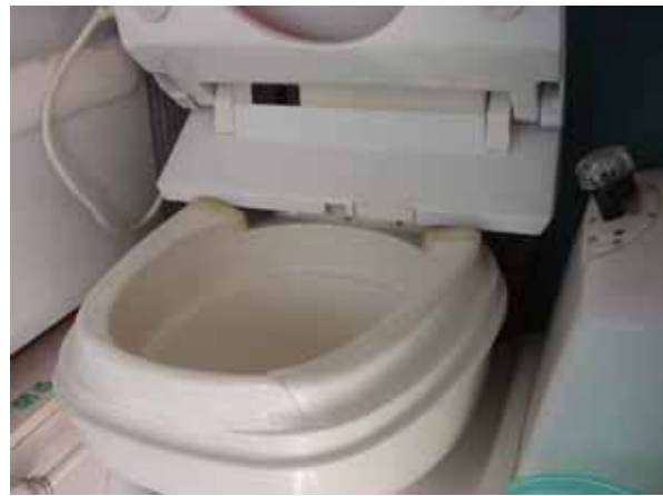
蓋を取外し、便座に合わせて Thetfordをカット&補強
