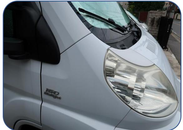
最後にぼかし剤を周りに塗布しました。塗料が乾いたらマスキングを剥がします。
