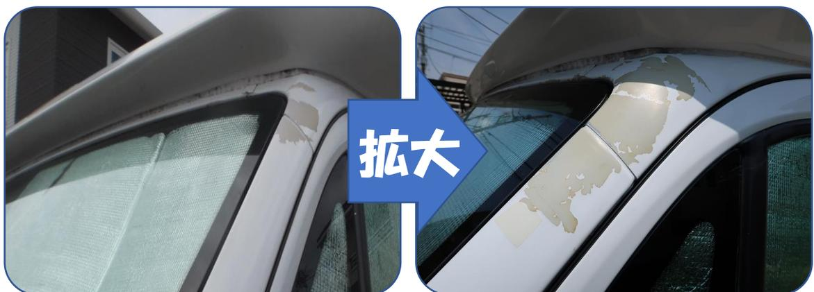
塗装の剥がれ始めは写真左、走るたびに少しずつ剥がれが広がっていく事に。塗装する事で、歯止めをかける事が出来るのか？ DIYで実験開始です。
